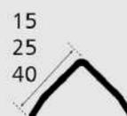
Perfil de ángulo recto de calidad aisi 304. Se instala para proteger los cantos de esquinas cerámicas y/o como remate de revestimientos.
